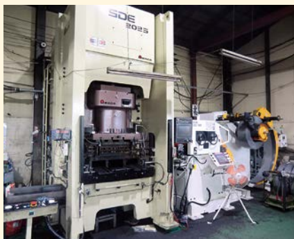
レーザーフィーダ(板厚6mmまで加工可能)
